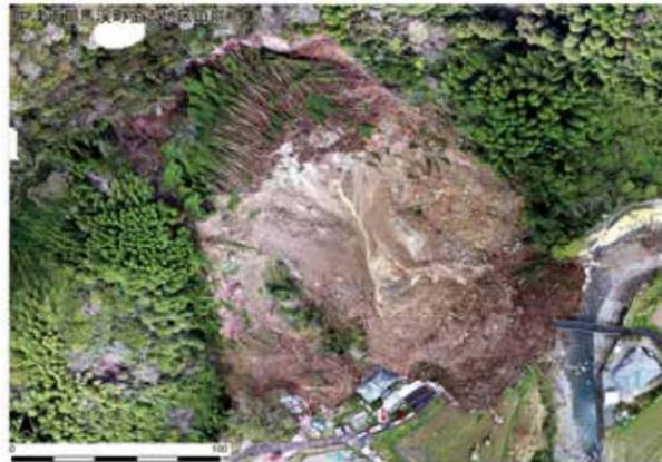
ドローン写真測量によるオルソ画像
